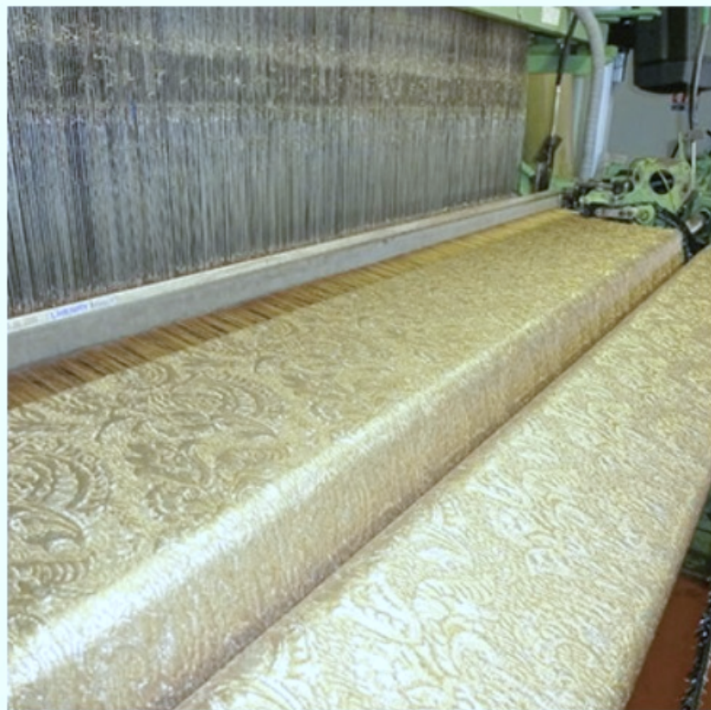
Tissage Jacquard de fils de soie pour la haute couture
