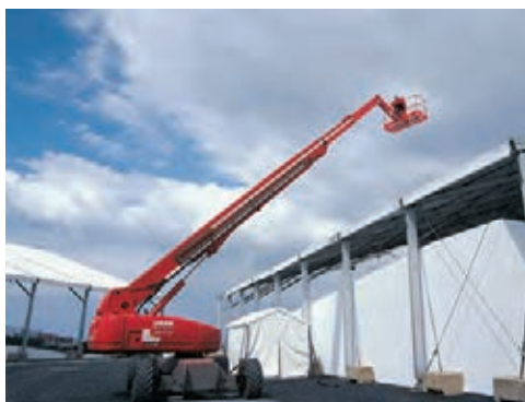
*PEMP : Plate-forme élévatrice Mobile de Personnes.
